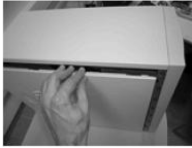
Рис. 3.1—3. Установка крышки корпуса системного блока
